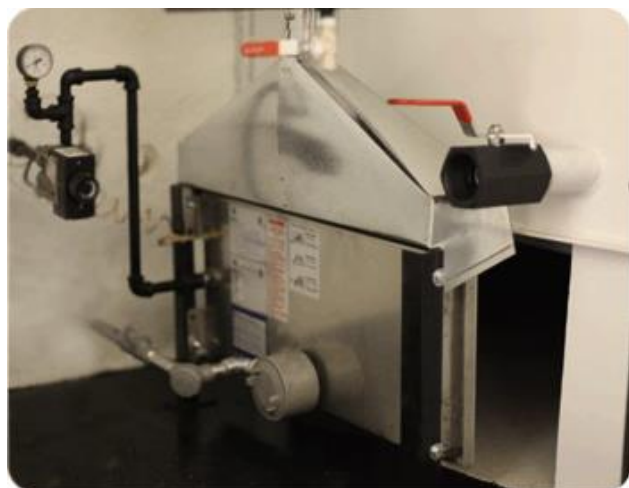
Обогрев резервуара с технологической жидкостью
